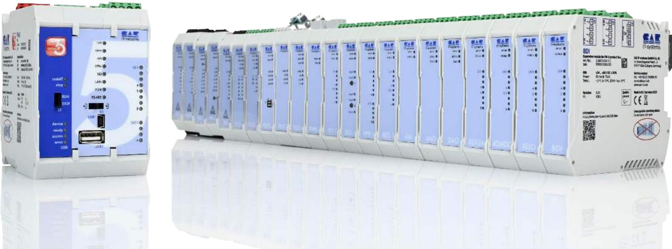
Das Mengengerüst des SAE-FW-5 kann anwendungsorientiert mit bis zu 12 Erweiterungsbaugruppen (EWB) ausgebaut werden. Mit dem Zubehör TBUS-T und TBUS-R können die EWB auch dezentral vom Basissystem abgesetzt platziert werden. Bei Konstellationen mit einem Strombedarf oberhalb der Möglichkeiten der Basiseinheit, kann die Stromversorgungsbaugruppe PWR-1 ergänzt werden.
