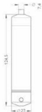
**Sensore di livello immersibile piezoresistivo di alta qualità con membrana in acciaio inox per la misurazione del livello dell'acqua potabile.**
