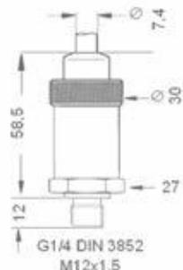
**Sensore di pressione piezoresistivo con attacco tipo gas da 1/4 di pollice DIN 3852 con membrana in acciaio inox di alta qualità per acqua pulita.**
