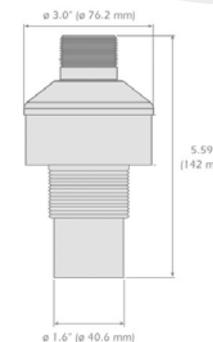
**Sensore a ultrasuoni (US) 0 - 3 m per la misurazione del livello senza contatto con l'acqua.**
