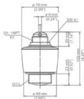
**Sensore radar 4 - 20 mA - 0 - 8 m per la misura di livello senza contatto con l'acqua.**
