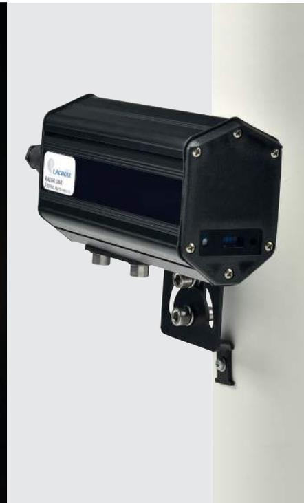
Dédié à la détection de véhicules, le radar de haute technologie SRM utilise le principe effet Doppler Fizeau à une fréquence de 24,125 Ghz, associé à un microcontrôleur de haute performance.
