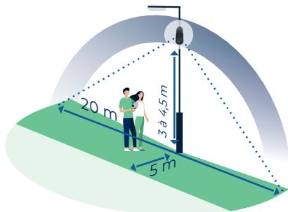
**ZONE 2 :** pour des applications nécessitant une réduction de la zone de détection sur les côtés.
