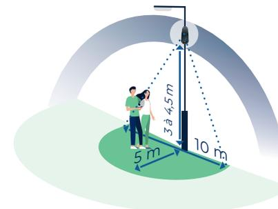
**ZONE 4 :** pour des applications nécessitant une zone de détection restreinte (ex. piste cyclable).
