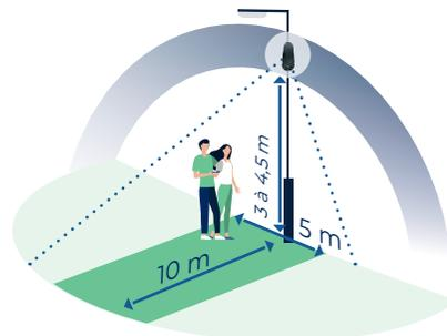
**ZONE 3 :** pour des applications nécessitant une réduction de l'ensemble de la zone de détection.
