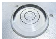
Réglage par niveau à bulle
